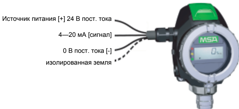
Рис. 5 3-проводное соединение — PrimaX P
